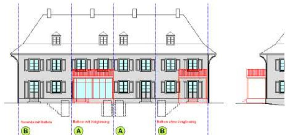
Abb. 3: Beispiel Baufelder für Anbauten
