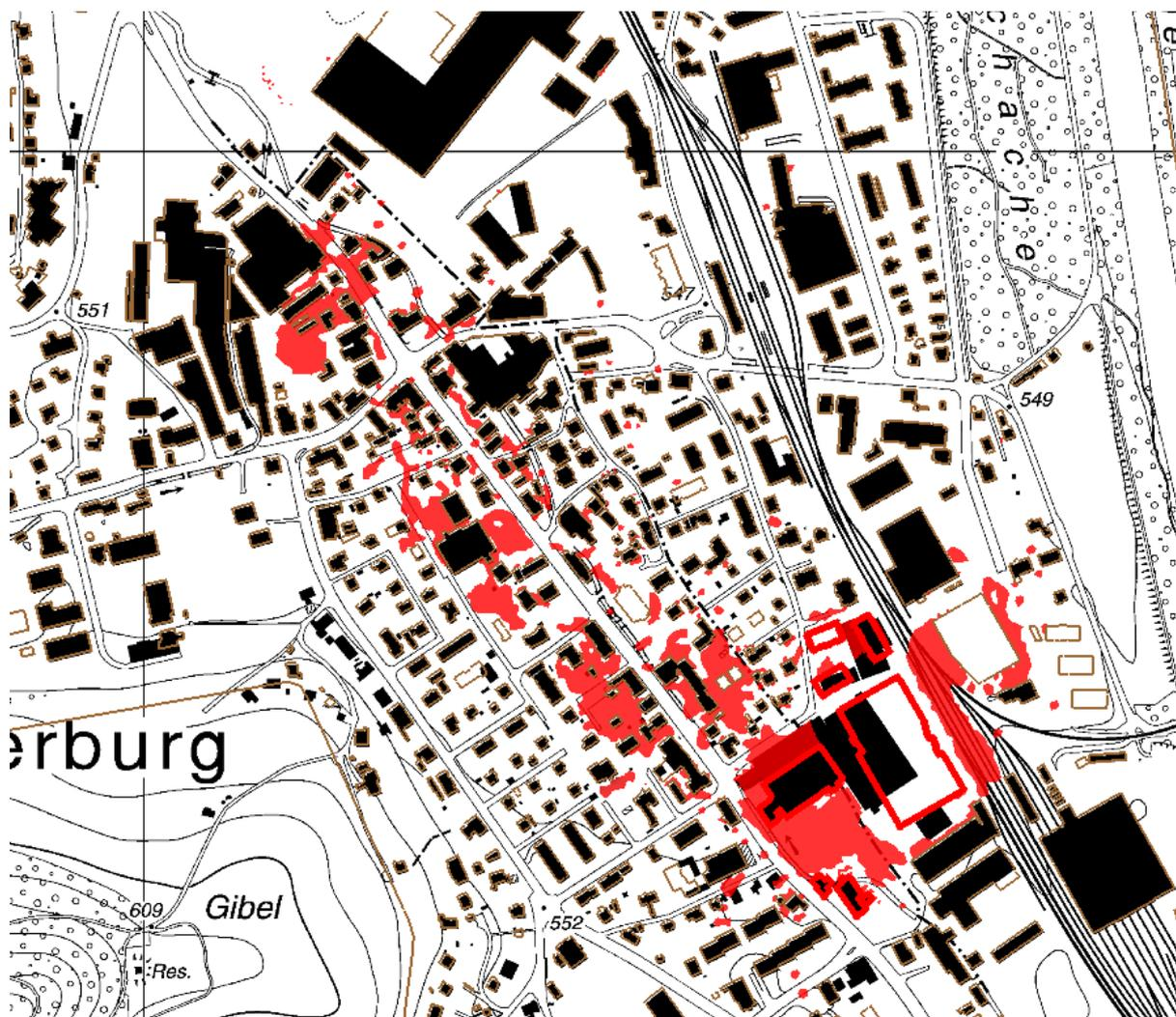
Abb. 6: Relevante Gefährdungsverlagerung (rote Flächen) durch den Projektzustand ohne flankierende Massnahmen
