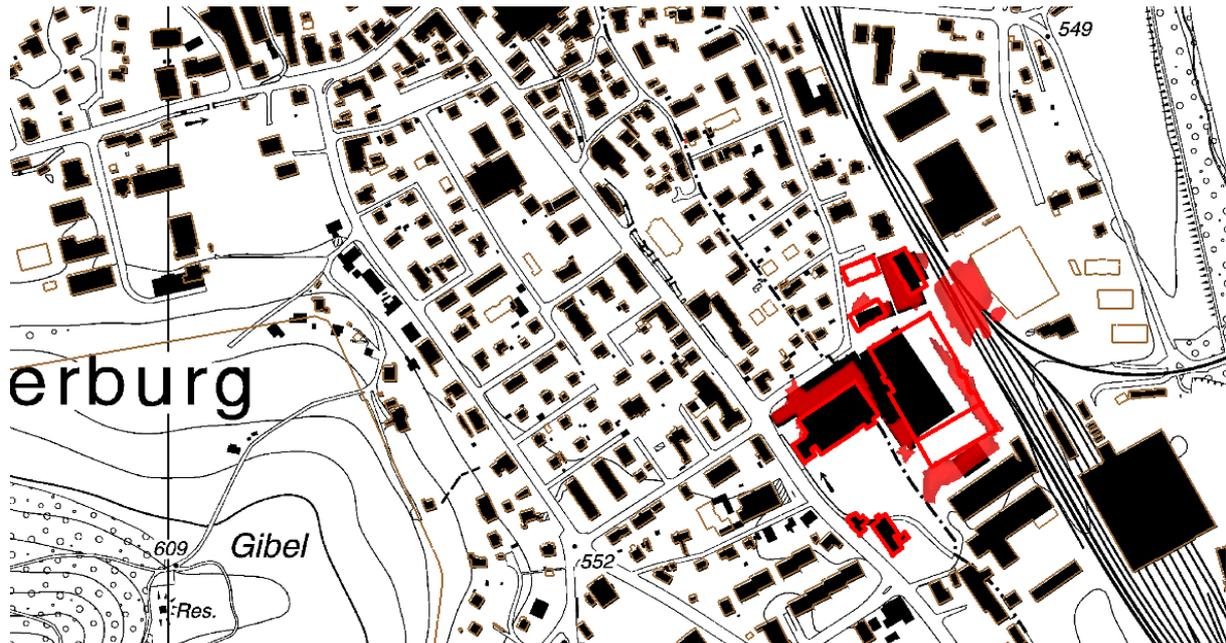
Abb. 22: Relevante Gefährdungsverlagerung (rote Flächen) durch den Projektzustand V7.2 mit flankierenden Massnahmen.
