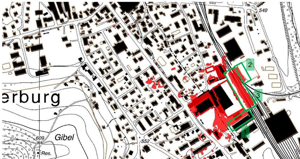
Abb. 13: Relevante Gefährdungsverlagerung (rote Flächen) durch den Projektzustand V2 mit flankierenden Massnahmen. Die abzuklärenden Bereiche auf Drittparzellen sind grün markiert.
